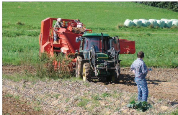
Untersuchung der Einstellung eines Kartoffel- roders mit Hilfe der elektronischen Knolle
