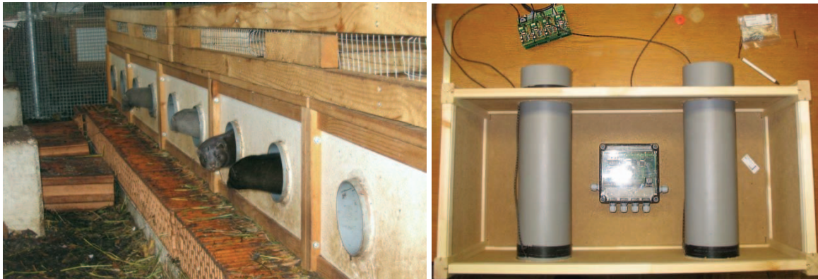
Links: Schlüpfen zu den Nestboxen der Nerze. Rechts: Einblick in die Schlüpfen beim Funktionstest mit Leseinheit und 4 Antennen (Draufsicht)
