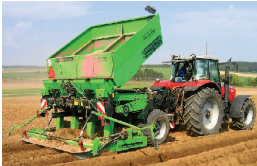
Im Jahr 2007 untersuchte Maschinen für das einphasige Direktlegen von Kartoffeln
