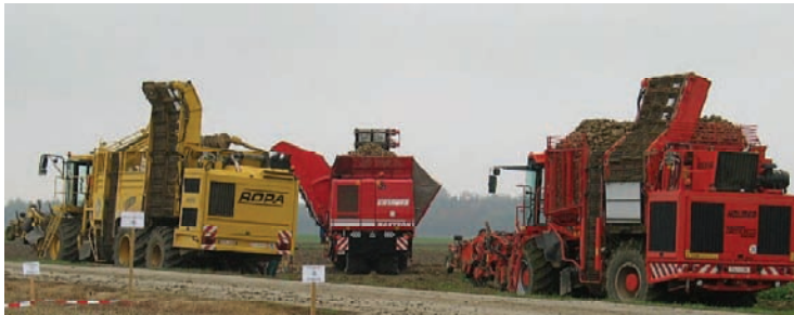
Sechsstufige Köpfrodebunker mit unterschiedlichen Fahrwerken
